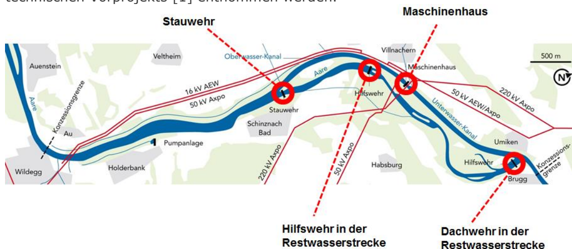
Abb. 3.1 Situation beim KWWB, Flussrichtung der Aare von links nach rechts (Quelle: Axpo).
