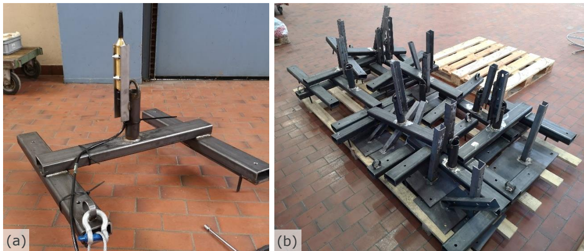
Abb. 4.4 (a) An einer H-Halterung befestigtes Hydrophon und (b) ein Teil der verwendeten C- und H-Halterungen.
